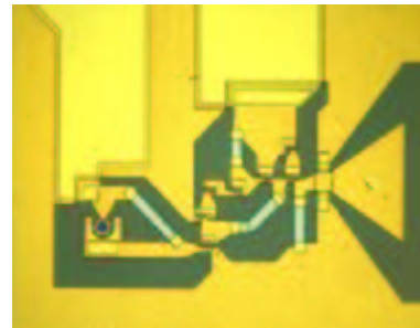
Verstärker für Datensignale bis 70 Gigabit/s (entworfen am Departement Elektrotechnik)
